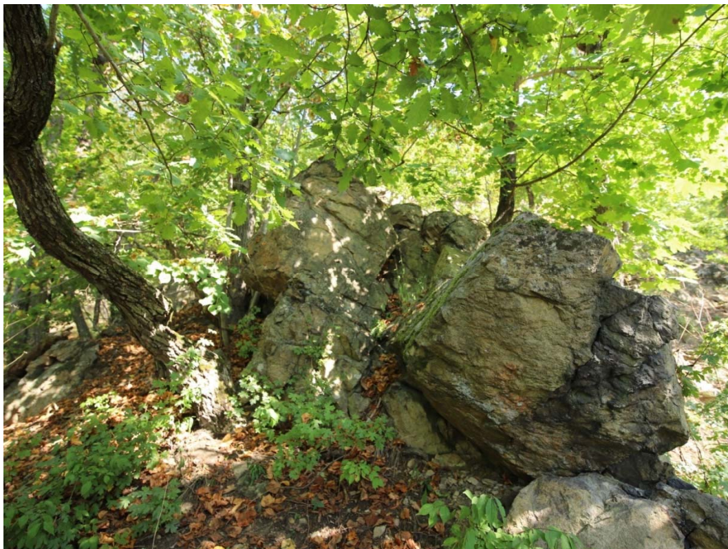
Obrázek 20: příklad bloků zcela odloučených a v rizikové pseudolabilní pozici ve výšce 3 – 5 m nad stezkou
