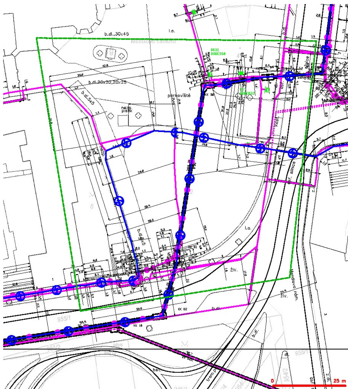
Obr. 19 – Podzemní vedení sítí elektronických komunikací, zdroj: CETIN a.s.
