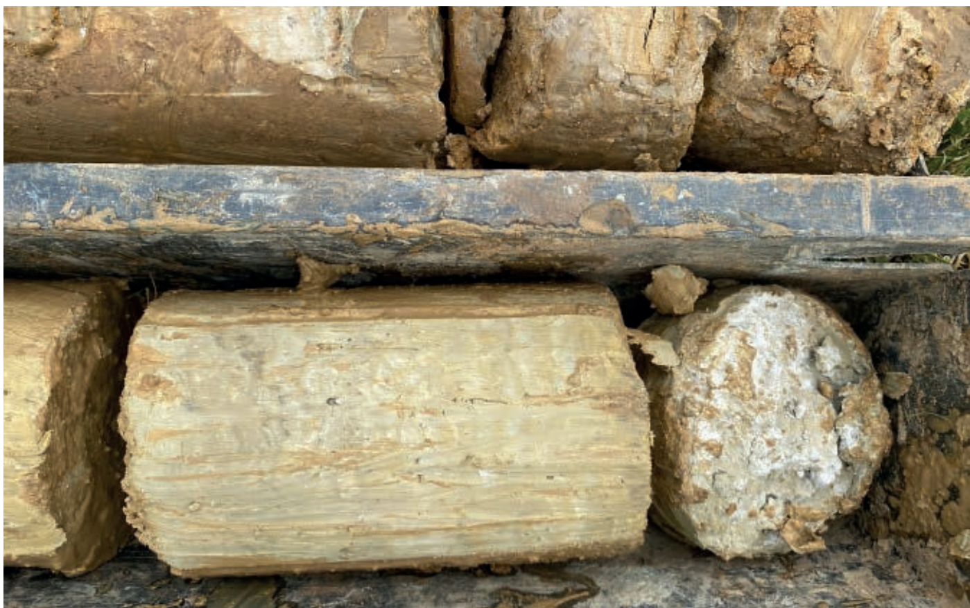
Detail jílovité zeminy z vrtu JV1
