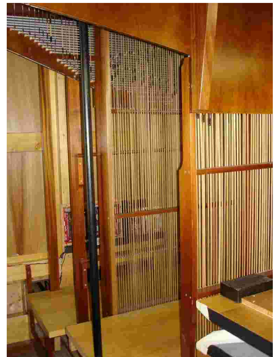
Uvnitř varháního stroje - mechanická traktura
