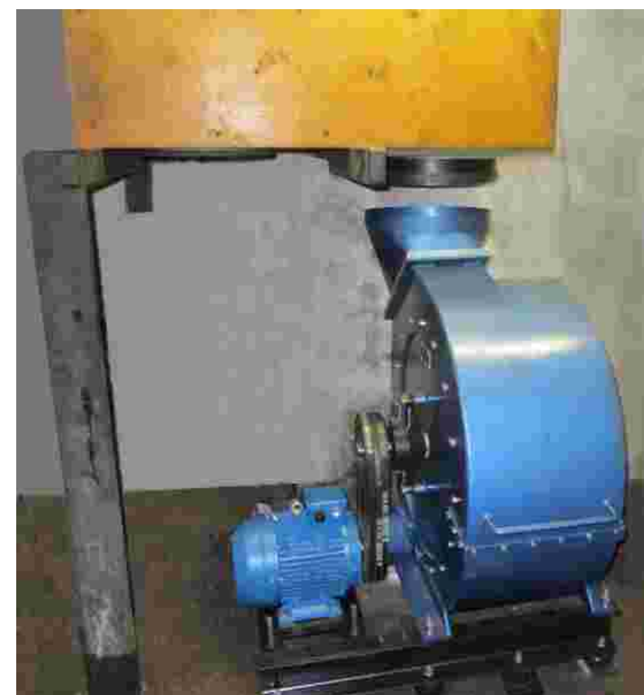
Ventilátor varhan - zdroj tlakového vzduchu
