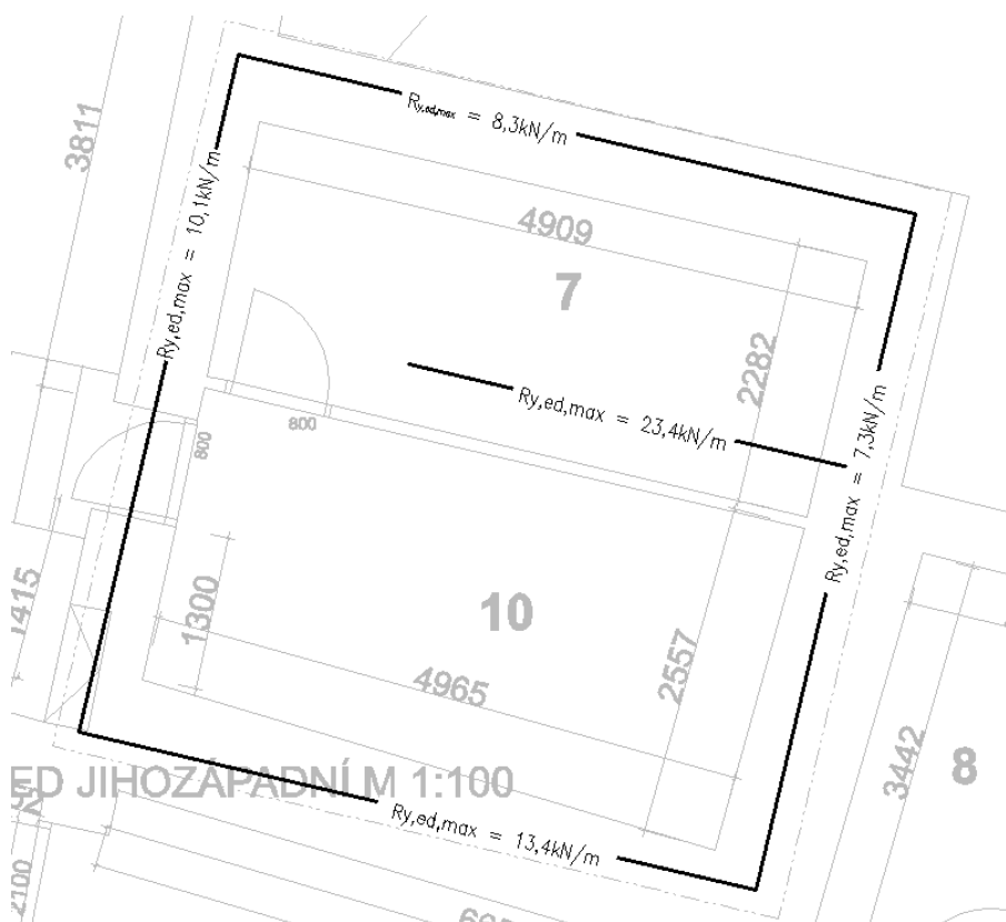
Liniové zatížení od SO02 ( dřevostavba + sokl ); návrhové hodnoty R_{y,ed,max}
