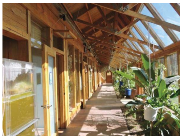
Přirozené stínění jižní fasády předsazenou konstrukcí skleníku.
