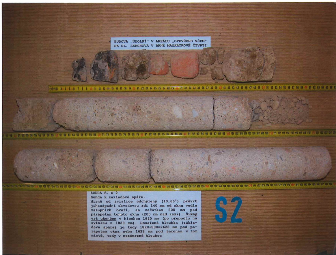
Obr.E55-02 Sonda č. S2 k základové spáře.
