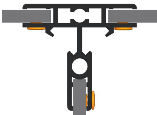
Detail půdorysu bočního hliníkového profilu
